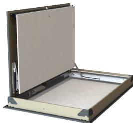
Večsektorska dimoodvodna loputa za stropno vgradnjo, z deklariranimi lastnostmi po EN 12101-8, testirana po EN 1366-10 in klasificirana po EN 13501-4. Sestavljena je iz eloksiранega aluminijastega okvirja, lamele, ključavnice in ključa, plinske vzmeti, priključne doze, blokirnega mehanizma, poteznega magneta in mejnega stikala. Upravljanje s pomočjo 24V električnega impulza. V normalnem stanju je zaprta, z električnim impulzom se odpre. Zapira se ročno s ključem.
