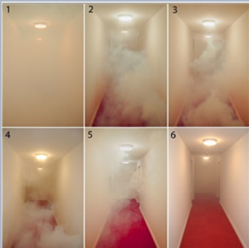
Slika: Odvod dima in toplote iz hodnika
